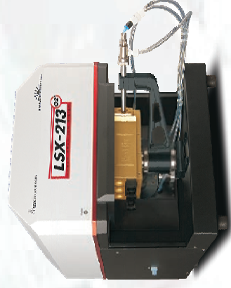
Fig. 4. Sistema di ablazione laser LSX-213 G2 con cella HelEx, campionamento e analisi diretta di solidi in ICP e ICP-MS.
