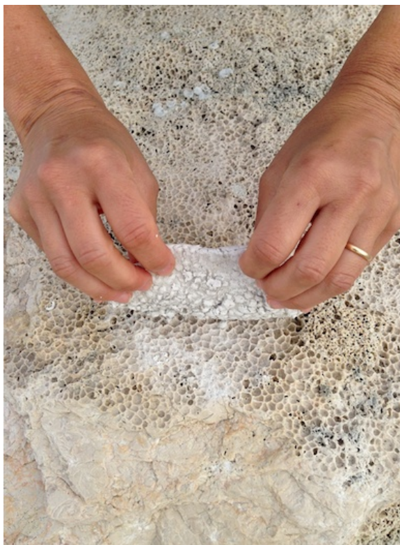
estrazione di un calco delle pietre d'Istria di una diga del Lido di Venezia
